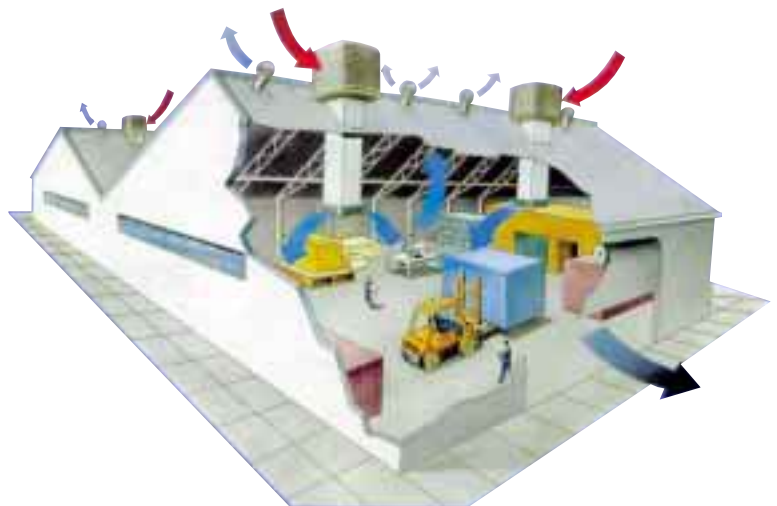
Esquema de instalación en naves industriales
