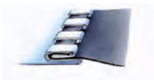
Detalhe bloqueio tipo LOC-4
